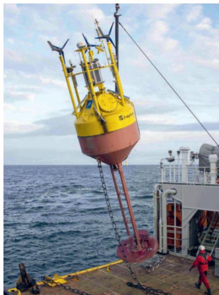
Eine der Fraunhofer IWES Wind-LiDAR-Bojen wird zu Wasser gelassen, um einen Offshore-Standort zu vermessen. Foto: BSH
