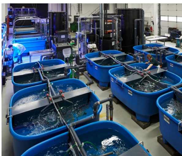
Eine Welt für sich: Im Zentrum für Aquakulturforschung laufen eine Reihe von in sich geschlossenen Kreislaufsystemen. Foto: AWI / Heiner Mueller-Elsner
